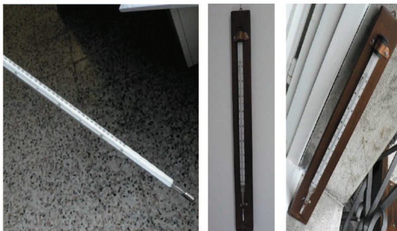
Figura 36: La strumentazione utilizzata, conservata presso il convento di San Bernardino – termometri a mercurio per la misura della temperatura dell'aria (Fondazione Biblioteca S. Bernardino, foto di Mirco Vinante)
