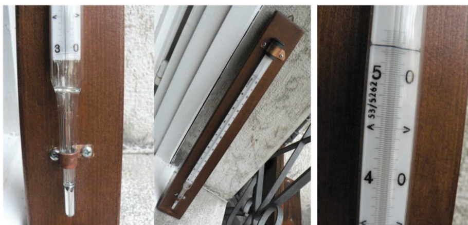
Figura 37: Strumentazione conservata presso il convento di San Bernardino – dettagli di uno dei termometri a mercurio, da cui si nota una risoluzione di 0.02 °C (Fondazione Biblioteca S. Bernardino, foto Mirco Vinante)
