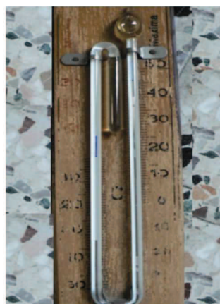
Figura 38: Strumentazione conservata presso il convento di San Bernardino – termometro a massima e minima (Fondazione Biblioteca S. Bernardino, foto di Mirco Vinante)
